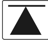
Рисунок 5.6.1 – Знак места установки домкрата
