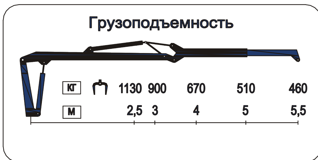
Рисунок 1.11 – Табличка грузоподъемности гидроманипулятора ГМ-42
