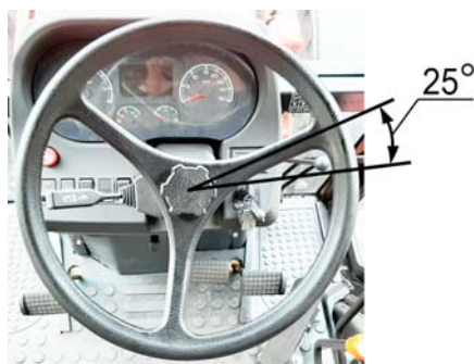
Рисунок 5.4.15 – Проверка люфта рулевого колеса
