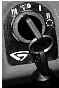
Рисунок 2.2.2 – Схема положений выключателя стартера и приборов
