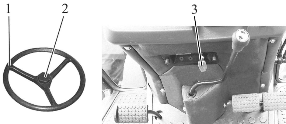
1 – рулевое колесо; 2 – зажим; 3 – рукоятка фиксации наклона рулевой колонки.
