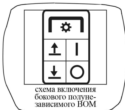
Рисунок 2.14.4 – Схема включения бокового ВОМ
