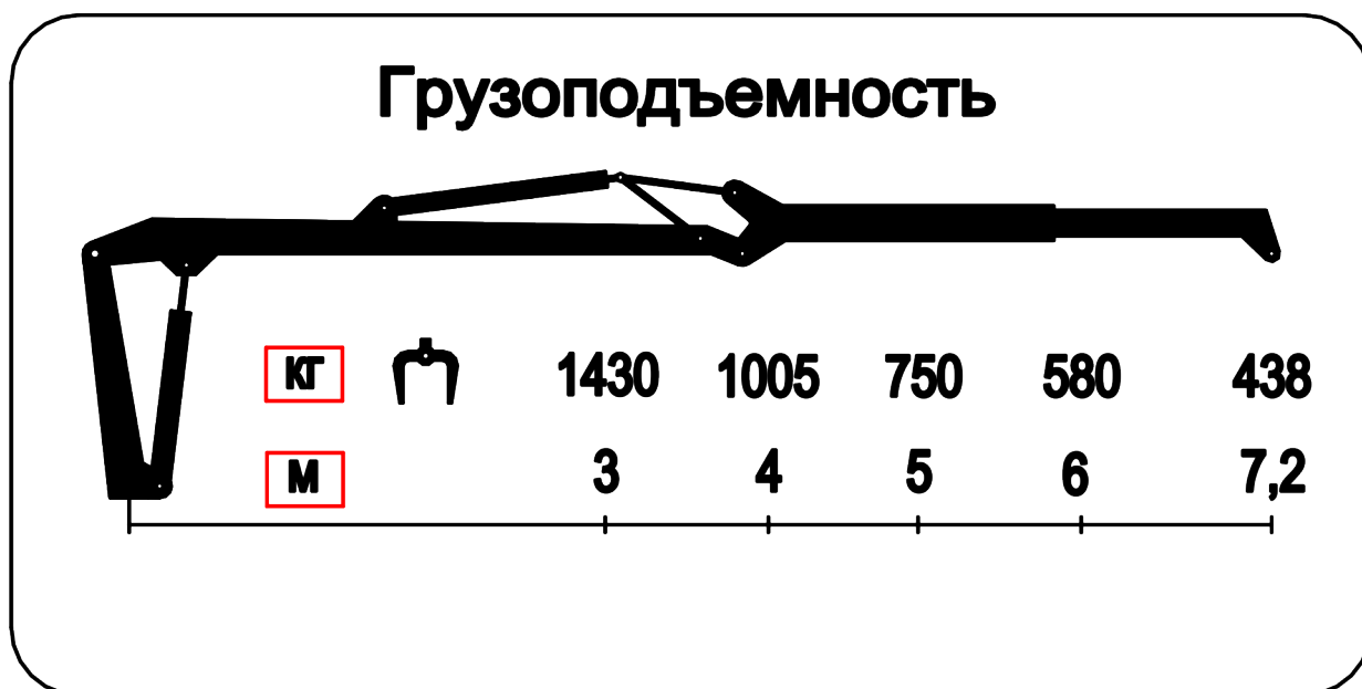
Рисунок 1.13 – Табличка зависимости допустимой грузоподъемности манипулятора от вылета стрелы манипулятора
