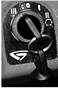
Рисунок 2.2.2 – Схема положений выключателя стартера и приборов
