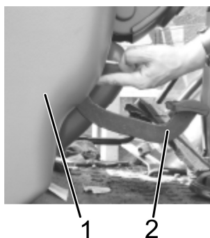
1 – пластиковая юбка панели приборов; 2 – педаль
