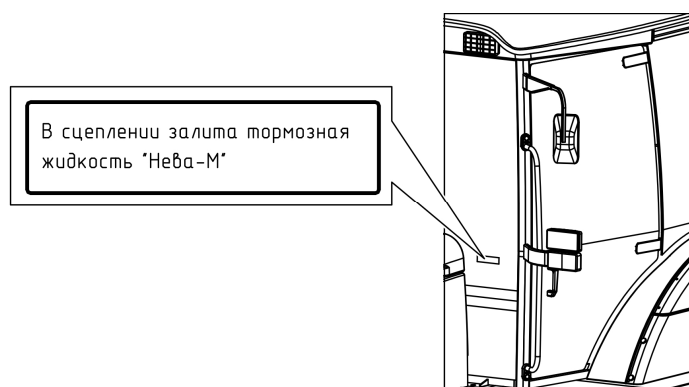
Рисунок 4.28 – Информационная табличка о заправленной РЖ в гидропривод сцепления
