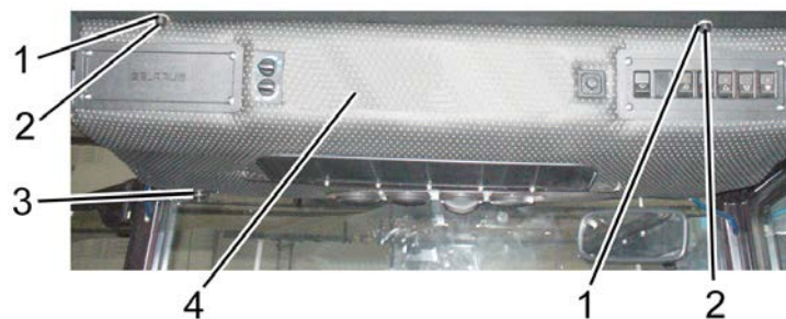
Рисунок 5.4.8 – Открывание верхнего отсека
