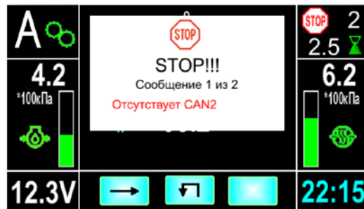
Рисунок 2.6.10 – Пример отображение критической неисправности
