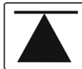
Рисунок 5.6.1 – Знак места установки домкрата
