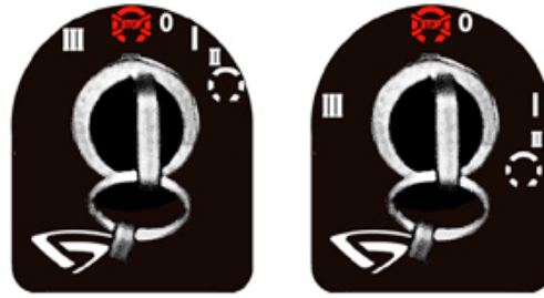
Рисунок 2.2.2 – Схема положений выключателя стартера и приборов
