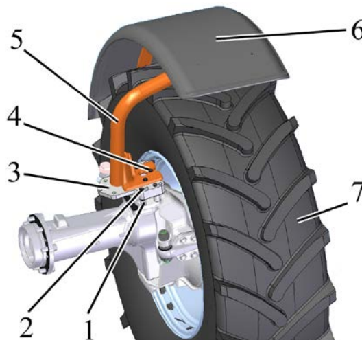
1 – втулка; 2 – болт; 3 – основание; 4 – болт; 5 – стойка крыла; 6 – крыло; 7 – переднее колесо.
