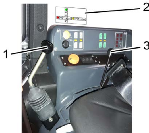
1 – джойстик, 2 – инструкционная табличка, 3 – рычаг.
