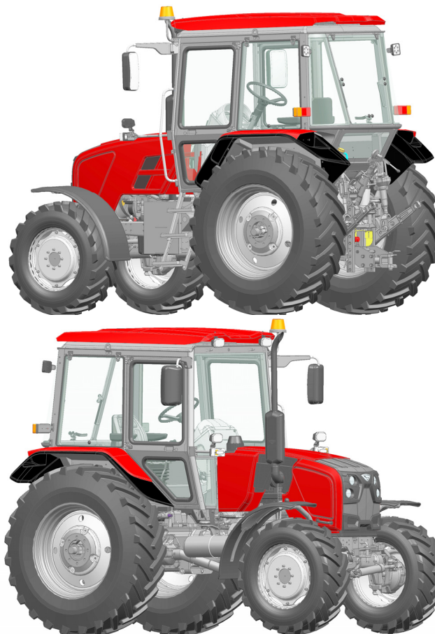
Рисунок 1.1.3 – Шасси «БЕЛАРУС-92П» в комплектации с ЗНУ, ТСУ и пневмоприводом тормозов прицепа (обновленный дизайн)
