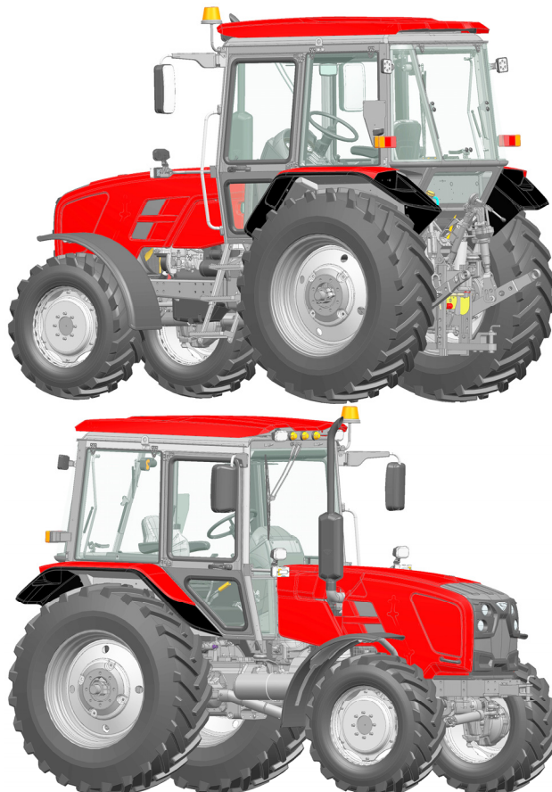
Рисунок 1.1.6 – Шасси «БЕЛАРУС-92П.4» в комплектации с ЗНУ, ТСУ, передними балластными грузами и пневмоприводом тормозов прицепа (обновленный дизайн)
