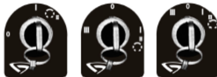
Рисунок 2.2.2 – Схема положений выключателя стартера и приборов
