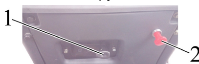
Рисунок 2.2.3 – Вариант установки рукоятки останова двигателя
