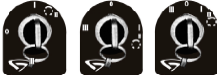
Рисунок 2.26.3 – Схема положений выключателя стартера и приборов
