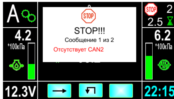
Рисунок 2.6.10 – Пример отображение критической неисправности
