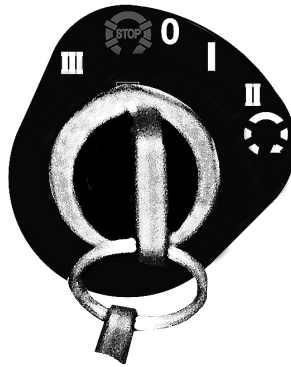
Рисунок 2.2.2 – Схема положений ключа выключателя стартера и приборов
