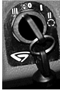
Рисунок 2.2.2 – Схема положений выключателя стартера и приборов
