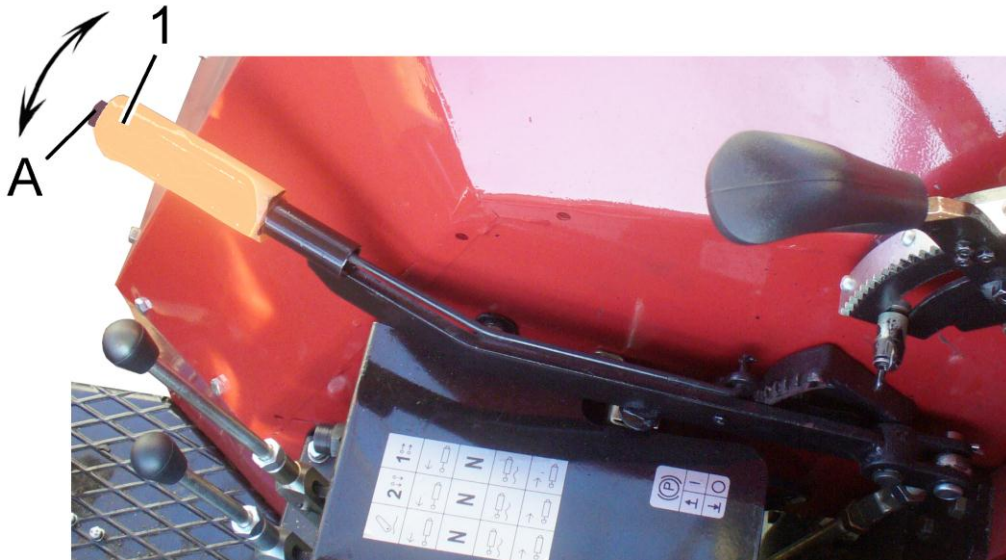
Рисунок 2.6.1 – Управление стояночным тормозом
